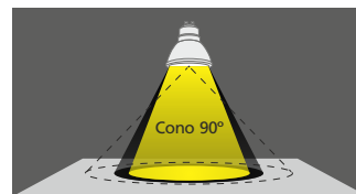
"Lúmenes útiles" medidos dentro de un cono de 90°
